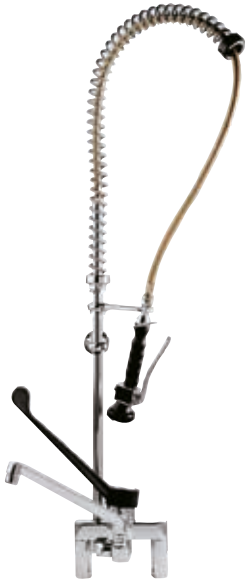
İki delikli duş ünitesi mikser musluk kollu, su girişi ve taban bağlantısı Ø3/4", mikser musluk gövdesi U=330 mm Y=230 mm
