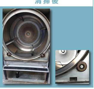
乾燥機は機械内・フィルターに埃がたまりやすく、燃焼不良の原因となります。燃焼不良を起こすと、洗濯物が十分に乾かな かったり、最悪の場合、火災の原因にもなりえます。予防保全として毎年の点検と消耗品交換をメーカーで推奨しておりま す。
